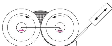
Автоматическое снятие порошного полотна
